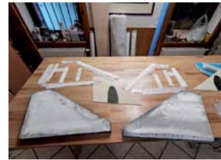
Rumpf, Tragflächen und Leitwerke entstehen aus Glasfaserverbundstoffen, die in Formen gepresst werden.
